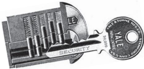
Der Yale-Zylinder aus dem Jahr 1865
